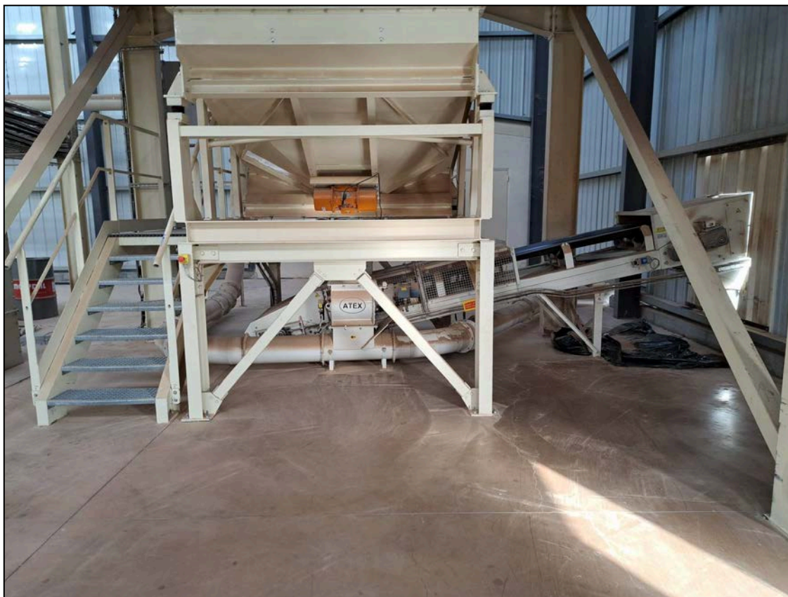
Figure 16 : Trappes des convoyeurs en sortie de sécheur (source : BIOSYL AUVERGNE)
